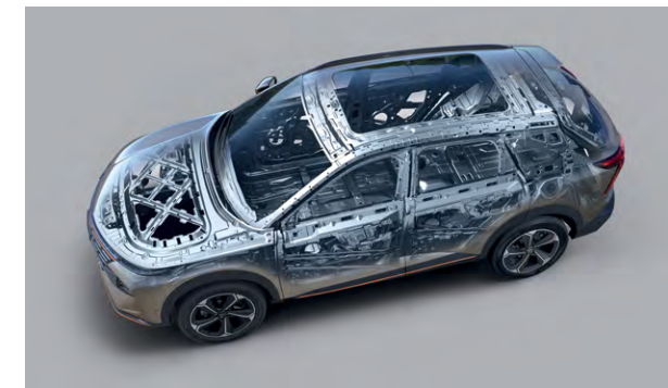
В структуре кузова используется 64% высокопрочных сталей
