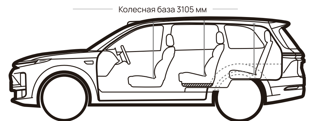
Пространство второго ряда: высота до потолка 1034 мм, пространство для ног 1071 мм. Пространство третьего ряда: высота до потолка 925 мм, пространство для ног 799 мм.
