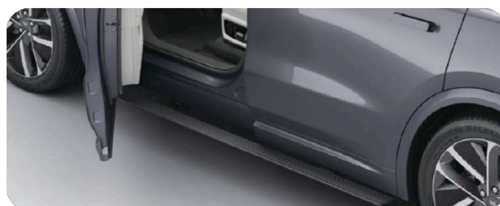
Выдвижные пороги с электроприводом 2
