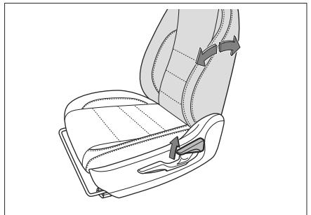
Плотно прислонясь к спинке сиденья, потяните рычаг регулировки наклона спинки, откиньтесь назад, приведя спинку в нужное положение, и отпустите рычаг.
