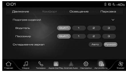
Коснитесь соответствующей кнопки на дисплее, чтобы отрегулировать уровень обогрева сиденья. При этом загорится индикатор.
